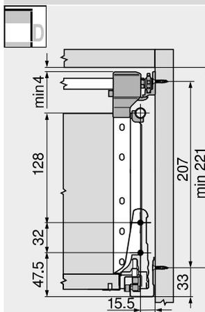
Posizione delle viti – stabilizzatore laterale
