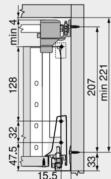
Posizione delle viti – stabilizzatore laterale
