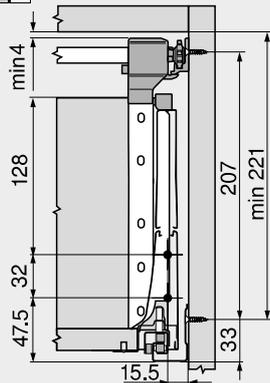
Posizione delle viti – stabilizzatore laterale
