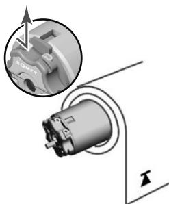
**5****FR** Paramétrage du fin de course bas**EN** Down limit adjustment**IT** Configurazione del finecorsa inferiore
