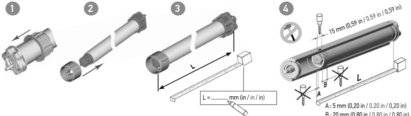
**3****ES** Instalación del tubo sobre sus soportes**PT** Instalar o tubo nos respectivos suportes**EL** Εγκατάσταση του σωλήνα στα σπηρίγματά του
