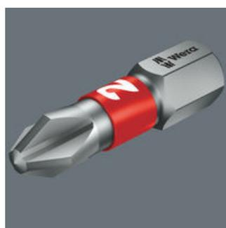
Gli inserti BiTorsion sono inserti di prima qualità. Con zona più morbida BiTorsion che permette di ridurre la durezza del gambo del 20 % rispetto a quella della punta. In questo modo si impedisce quasi del tutto che, in presenza di carichi elevati, la punta dell'inserto si deformi, allungando ulteriormente la durata dell'inserto.
