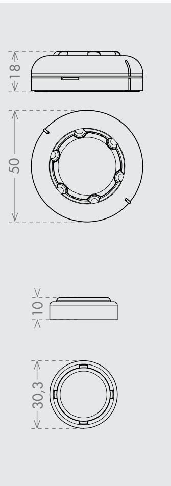
**FR** Le bloque volet magnétique est l'alternative idéale aux bloques-volets traditionnels. L'installation est possible aussi bien sur les parois enduites que sur les parois isolantes, grâce à une série de cales conçues à cet effet. La force magnétique est réglable grâce à des épaisseurs qui, déplacées à l'intérieur de l'élément à la paroi, permettent d'augmenter ou de diminuer le tirage entre les aimants.
