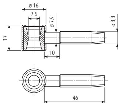
**NB.** Forare con punta  $\varnothing 7,7$  mm.
