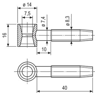
**NB.** Forare con punta  $\varnothing 7,2$  mm.
