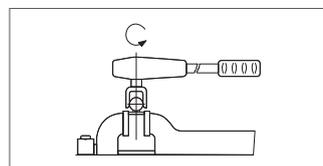
Prova a torsione con chiave dinamometrica. La saldatura deve garantire una resistenza non inferiore ai 50Nm
