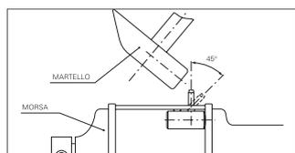
Prova ad urto con (martello) piegatura min 45° senza presenza di cricche o cedimenti.
