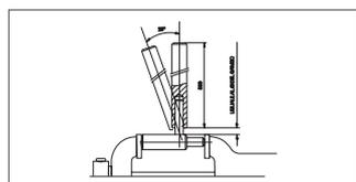
La saldatura deve resistere alla piegatura del gambo fino a raggiungere un angolo di almeno 20°.
