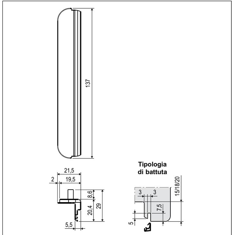
**Esempi di applicazione per profili con guarnizione ridotta**
