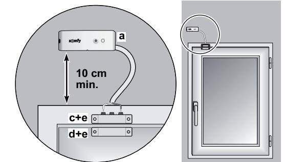
Sie müssen dabei die im Lieferumfang enthaltenen Ausgleichsscheiben (e) unter dem Magnetschalter (c) und unter dem Magneten (d) anbringen, um den Kabeldurchgang nicht zu behindern
