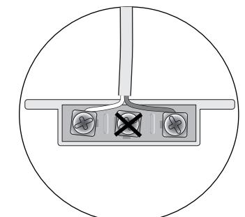
Schrauben Sie den Magnetschalter und das Aufbaugehäuse an. Verwenden Sie dafür keine Flachkopfschrauben.
