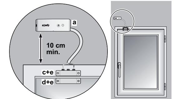
Utilizzare **tassativamente** gli spessori (e) in dotazione posizionandoli sotto il blocco terminale (c) e sotto il magnete (d) per semplificare il passaggio del cavo.
