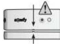
Posizionare il sensore all'interno dell'abitazione, **sul montante del serramento**, orizzontalmente o verticalmente, sul lato di apertura (posizione opposta ai cardini).
