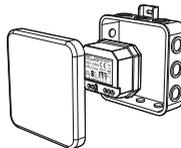
Montage dans une boîte encastrée IP20 (**non fournie**) à proximité de l'appareil qu'il doit commander et à l'abri des projections d'eau.
