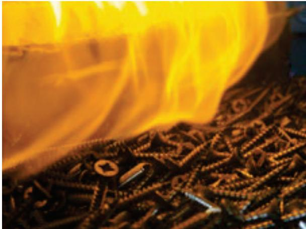
Processo con il quale si conferiscono alla vite le **caratteristiche di durezza e tenacità necessarie ad avvitare o perforare i differenti materiali**. È un processo termochimico, eseguito in sofisticati forni di cementazione, che si svolge in due fasi:
