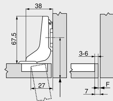
Arretrare la posizione di fissaggio della piastrina di premontaggio dello spessore del frontale FD +1.2 mm
