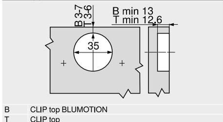
Sistema di montaggio INSERTA
