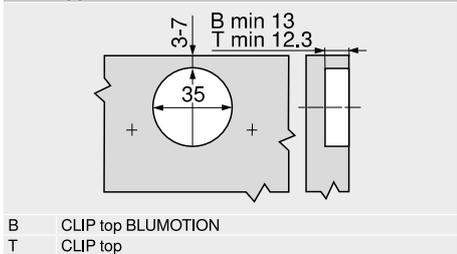
Sistema di montaggio INSERTA
