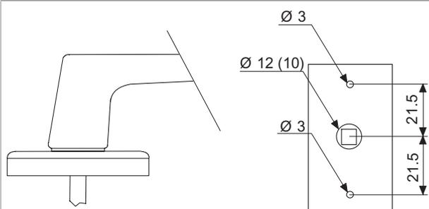
Adatta per profilati in PVC nei quali la struttura a camere e/o la presenza del rinforzo permette di avvitare direttamente sul profilato, anzichè negli inserti.
