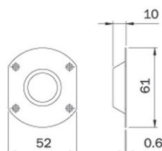
Ghiera concava in ottone per cilindro a pompa, foro cilindro  $\varnothing$  mm 27.
