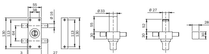
Serratura da applicare di sicurezza reversibile VIS. **CHIUSURA LATERALE**
