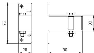
Incontro standard superiore a cavallotto per aste Ø mm 18 serie 990063-990067. Perno con bussola guida asta regolabile. VERNICIATO BRONZO.
