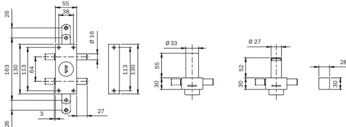
Serratura da applicare di sicurezza reversibile VIS. **CHIUSURA TRIPLICE**. Laterale a due pistoni  $\varnothing$  mm 16, una mandata da mm 27. Verticale alto/basso con foro predisposto per aggancio aste, escursione mm 26. **BUSSOLA GUIDA-CHIAVE INTERNA**. Due guida aste. Sbalzo mm 35 per aste. Incontro a cavallotto superiore. Boccola a pavimento. 3 CHIAVI A POMPA.
