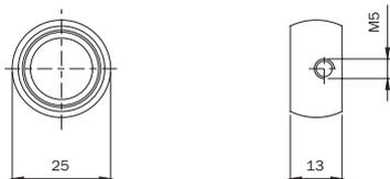
Anello in ottone per bloccaggio aste telescopiche serie 990063-990067 con grano di fissaggio. **990123** 10 - 10
