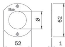
Ghiera piatta in ottone per cilindro a pompa, foro cilindro  $\varnothing$  mm 27.
