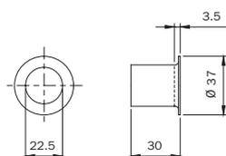
Boccola a pavimento in ottone per aste. Foro interno  $\varnothing$  mm 22,5.
