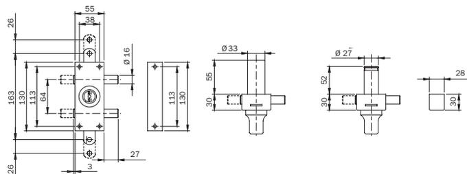
Serratura da applicare di sicurezza reversibile VIS. **CHIUSURA TRIPLICE**. Laterale a due pistoni  $\varnothing$  mm 16, una mandata da mm 27. Verticale con alto/basso con foro predisposto per aggancio aste, escursione mm 26. **CILINDRO A POMPA INTERNO NICHELATO**. Due guida aste. Sbalzo mm 35 per aste. Incontro a cavallotto superiore. Boccola a pavimento. 3 CHIAVI A POMPA.
