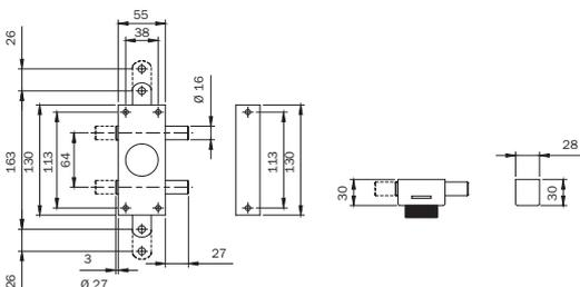
Serratura da applicare di sicurezza reversibile VIS. Verniciata BRONZO. **CHIUSURA TRIPLICE**, laterale a due pistoni  $\varnothing$  mm 16, una mandata da mm 27, verticale alto/basso con foro predisposto per aggancio aste, escursione mm 26. **POMOLO INTERNO. SENZA CILINDRO ESTERNO, SENZA CHIAVI**. Due guida aste. Sbalzo mm 35 per aste. Incontro a cavalletto superiore. Boccola a pavimento. Incontro senza aletta. Viti di fissaggio.
