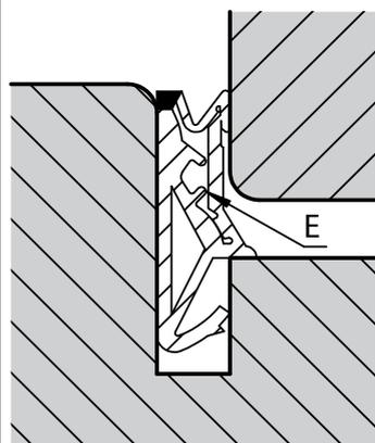
**A - Risparmio** ovvero minori possibilità di scarti nella lavorazione col tronchese, dato che uno speciale cordone in materiale più duro, permette di realizzare angoli che non si fessurano perché resistenti agli strappi.
