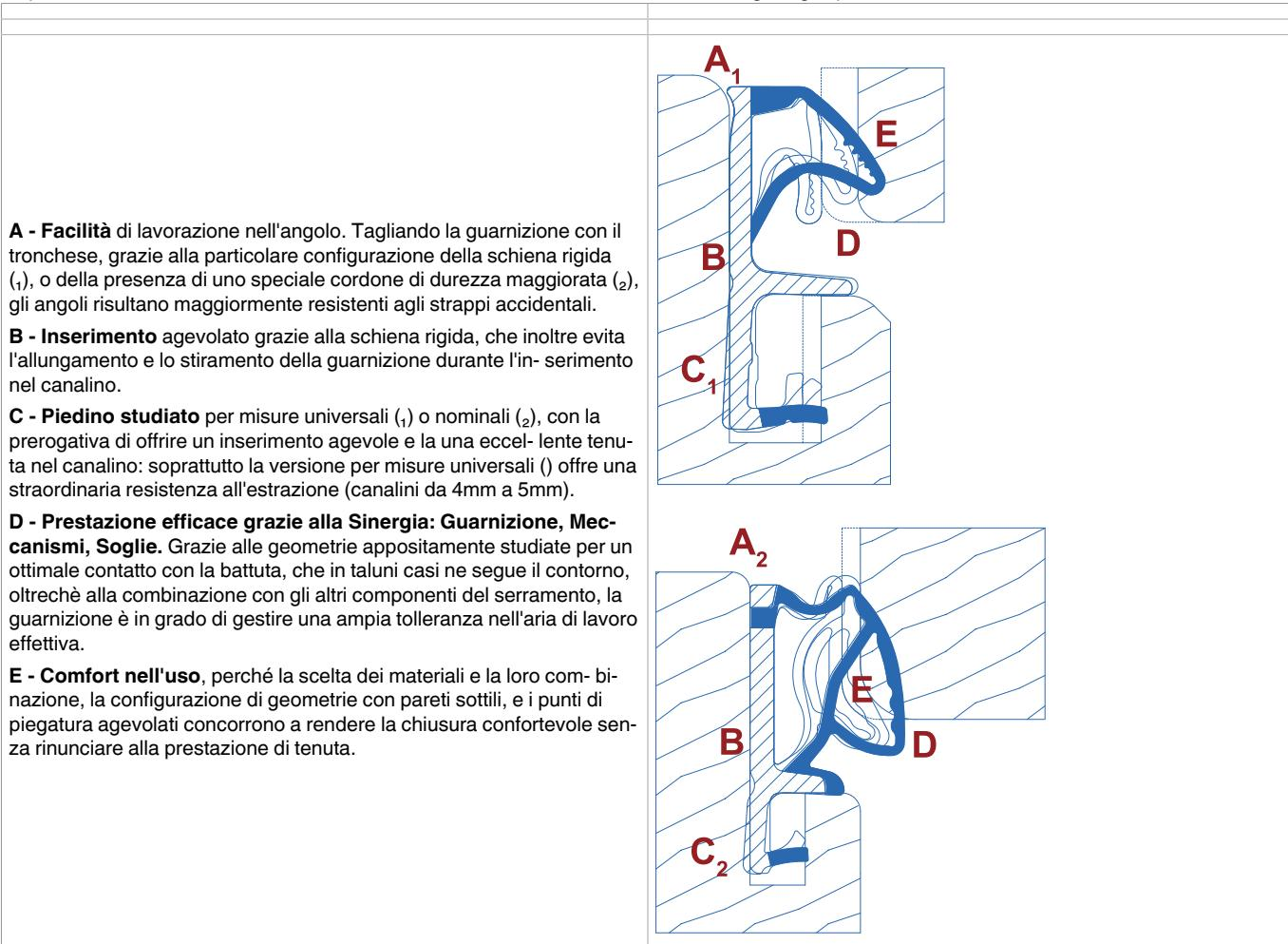
**A - Facilità di lavorazione nell'angolo.** Tagliando la guarnizione con il tronchese, grazie alla particolare configurazione della schiena rigida (1), o della presenza di uno speciale cordone di durezza maggiorata (2), gli angoli risultano maggiormente resistenti agli strappi accidentali.
