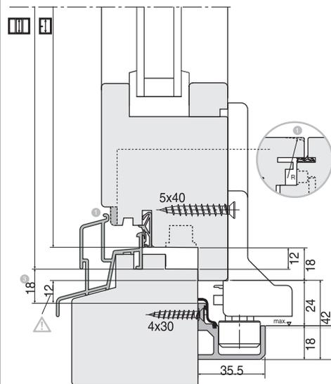
1. Smussare il battente sotto e sopra, in prossimità del carrello e della guida
