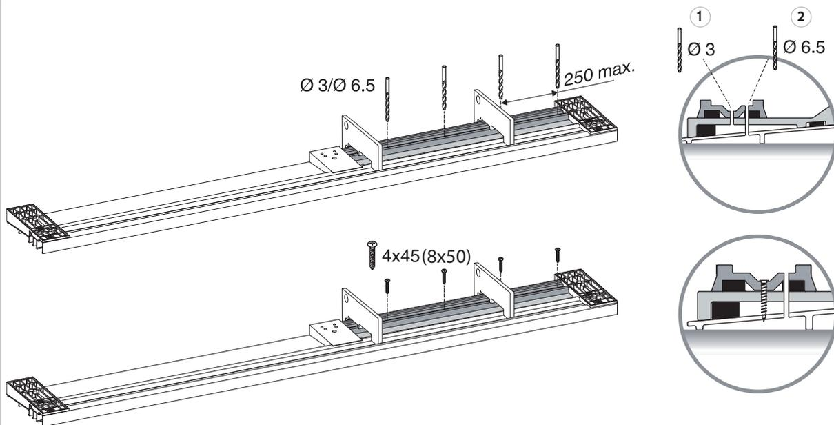
Possibilità di fissaggio dal alto tramite foro di Ø 3 mm (1), oppure tramite foro di Ø 6 mm (2)
