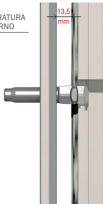
La microventilazione di 13,5 mm permette di avere un riciclo di aria continuo ma limitato al fine di evitare il raffreddamento eccessivo della stanza.
