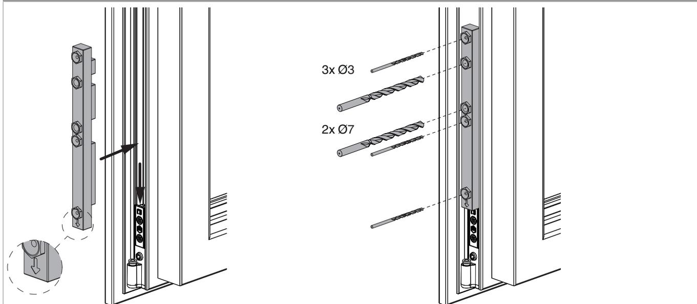
1. Inserire correttamente la dima cod. 228518 (la freccia rivolta in basso) nella cava ferramenta.
