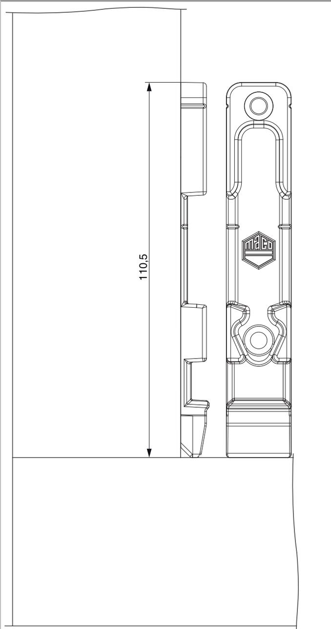
**Montaggio:** Montare lo scontro ribalta direttamente nell'angolo.
