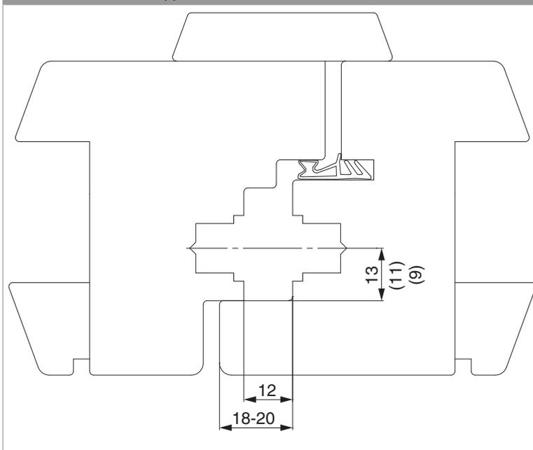
Profilato ad U in alluminio per cava ferramenta per asta a leva
