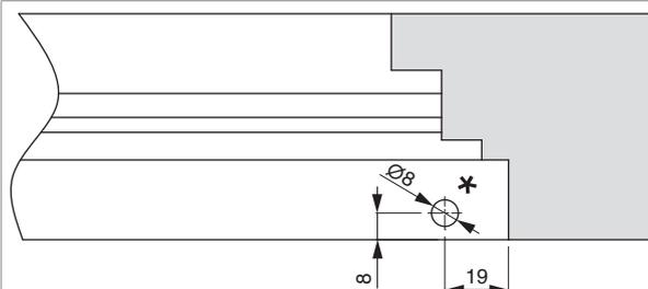
• Viti di sostegno devono essere utilizzati per finestre in legno con un peso per anta oltre 100 kg!
