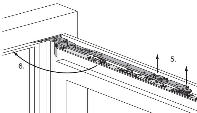
5. Alzare l'asta forbice, per liberare il perno di guida. Tenere il battente in posizione.
