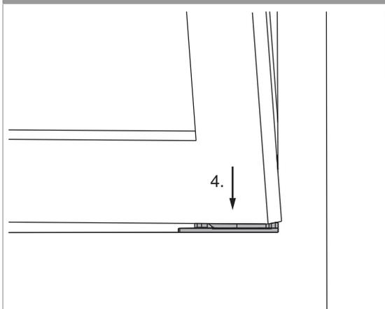
4. Inserire il battente leggermente inclinato a ribalta e parallelo al telaio, in entrambi i perni del supporto cerniera. Aprire il battente a 90°.
