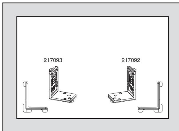
• Inserire la dima (217093 - cerniera sinistra, 217092 - cerniera destra) come illustrato e preforare con punta  $\varnothing 3$  mm.
