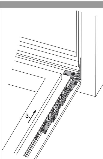
3. Posizionare l'anta col frontale cerniera ribalta parallelamente al braccio cerniera ribalta.
