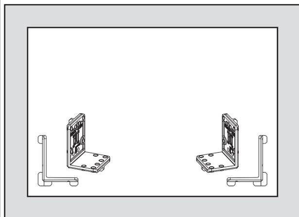
• Appoggiare la dima foro (217094) come illustrato e preforare con punta  $\varnothing 3$  mm.
