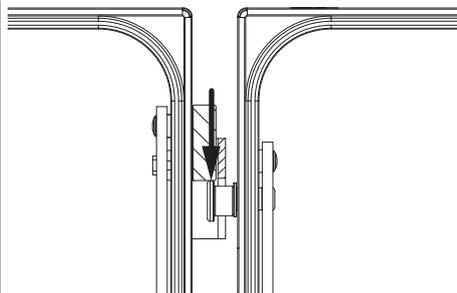
Se si verifica un tentativo di scasso e la leva viene forzata dall'esterno, la slitta di bloccaggio preme sui funghi, impedendo l'apertura.
