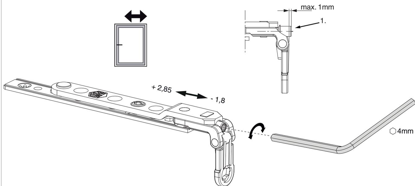
1. Durante l'abbassamento dell'anta assicurarsi che la vite non fuoriesca completamente. La testa della vite deve sporgere al massimo 1 mm!
