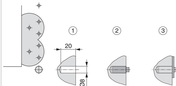
1. Forare con punta Ø 8 nel foro inferiore della dima. Profondità del foro 20 mm.
