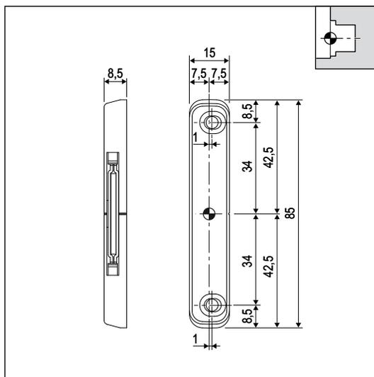
Parte telaio, aria 12 mm, interasse 9 mm, sede 18 mm
