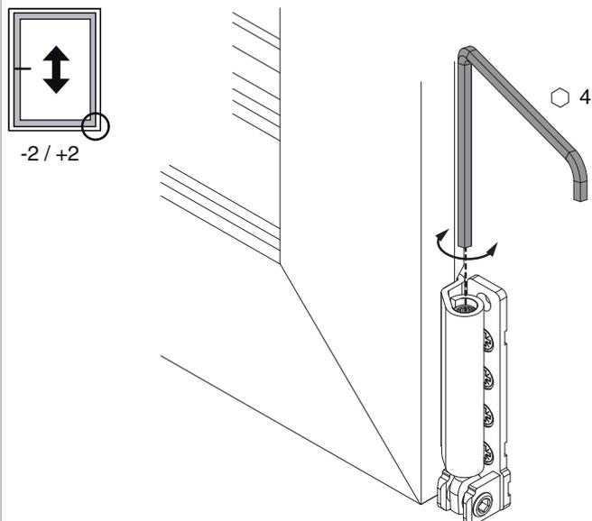
• **Regolazione:** L'angolo cerniera può essere regolato in altezza utilizzando una chiave a brugola da 4 mm (cod. 41017). Per migliorare la praticità di utilizzo, la vite di regolazione dell'altezza è stata costruita in modo che la chiave a brugola possa essere agganciata ogni 30°.
