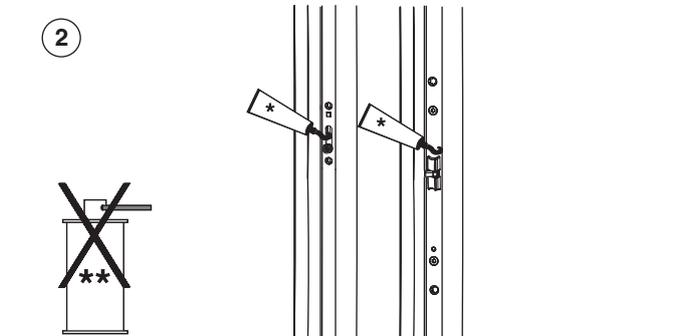
1) La scatola serratura viene fornita con una lubrificazione costante con grassi di alta qualità, di conseguenza NON è necessario lubrificarla nuovamente! Lubrificare scrochi e mandata una volta all'anno!
