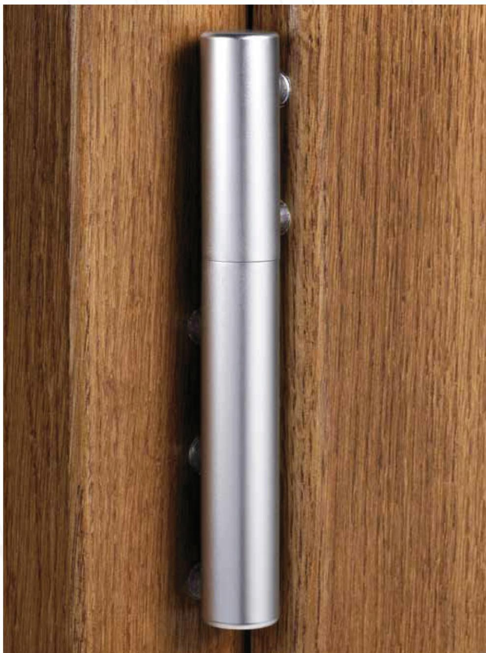
Con i suoi 5 gambi, garantisce stabilità, portata ed un perfetto allineamento dell'anta. Adatta a porte e portoni particolarmente pesanti e con ante particolarmente grandi, permette la regolazione verticale, laterale ed in profondità. Il maschio a 3 gambi è intercambiabile con diverse versioni di Exacta come riportato nella parte finale di questa brochure. Disponibile nei diametri da 16 e 18 millimetri.
