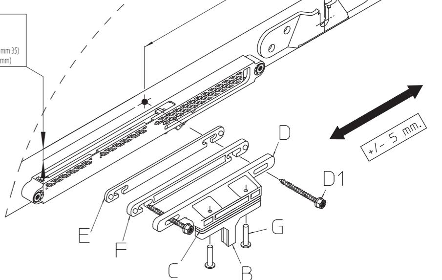
\*Fissare la staffa di chiusura "B" in accoppiamento con il distanziale "C" sul traverso. Utilizzare le viti in dotazione "B1" TC Ø3,5x40 DIN 7505-B. Per il suo posizionamento fare riferimento alle quote indicate. Aggiungere o togliere i distanziatori "C" in dotazione per ottenere il giusto accoppiamento verticale tra staffa "B" ed il sistema di chiusura "A".
