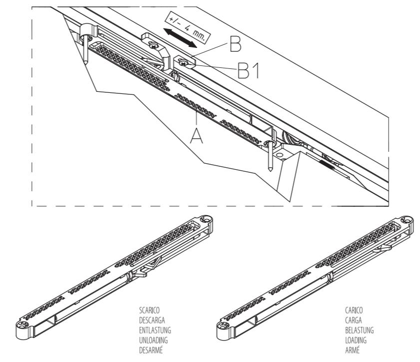
\*Installato il pannello, portarlo in chiusura ed apertura e regolare, se necessario, la staffa "B" allentando le viti "B1".
