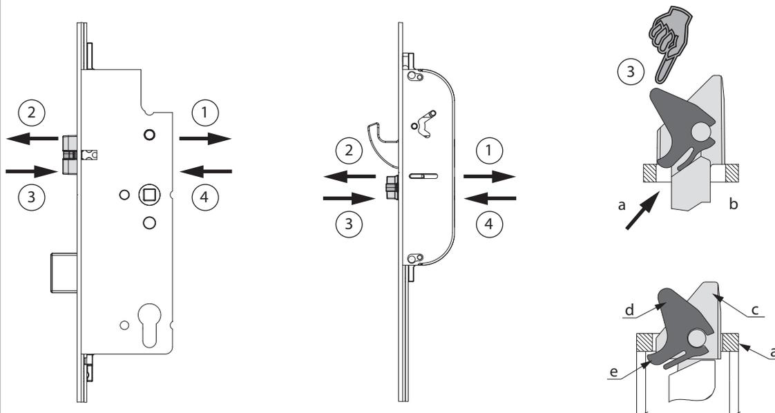
1) Allentare completamente la vite e spingere lo scrocco in avanti con il cacciavite!
