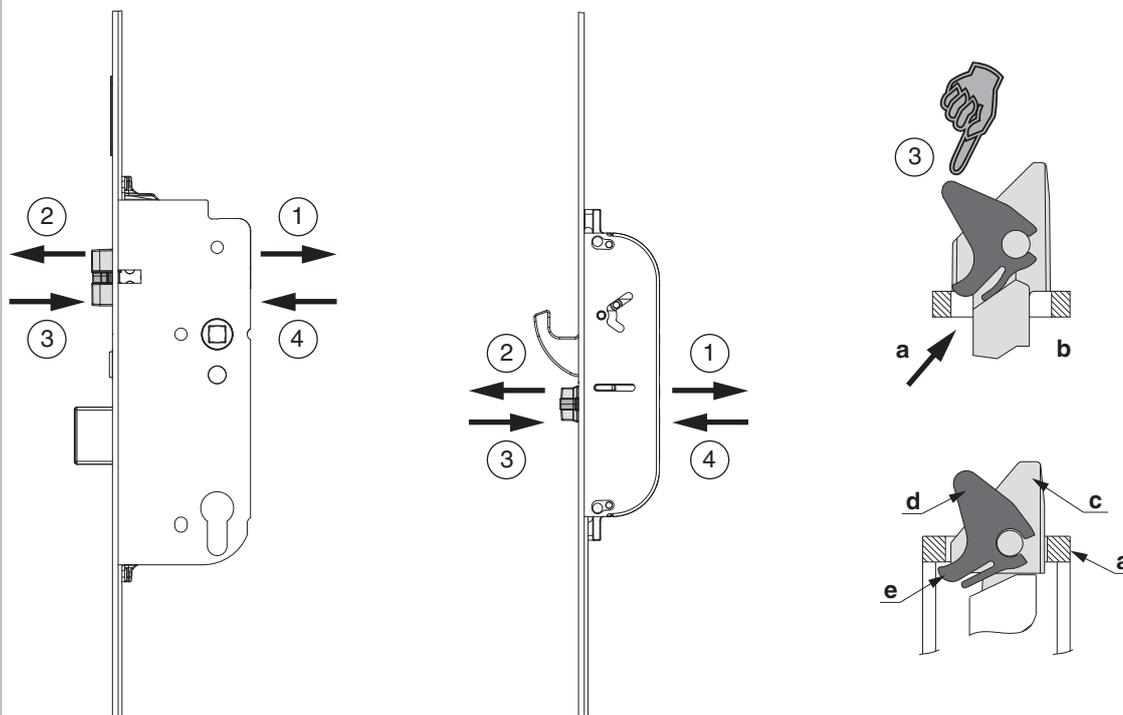
1) Allentare completamente la vite e spingere lo scrocco in avanti con il cacciavite!
