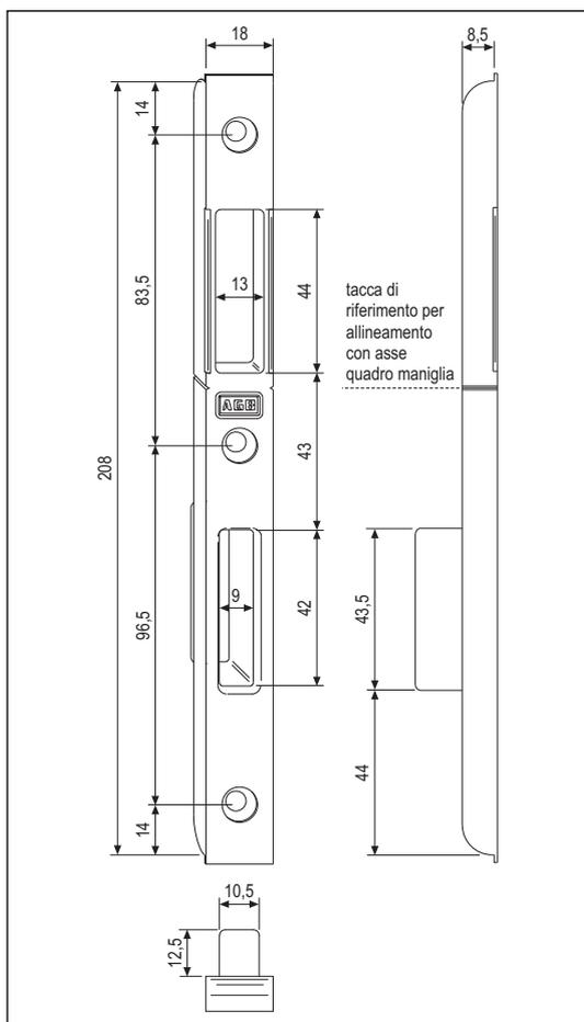
Per serrature frontale 16 mm, interasse 85 mm
