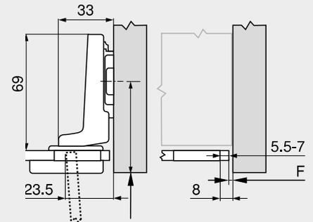
Arretrare la posizione di fissaggio della piastrina di premontaggio dello spessore del cristallo più l'altezza del coprifondello +3 mm
