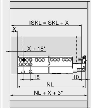
\* +1 mm in caso di montaggio della guida prima di assemblare il corpo mobile
