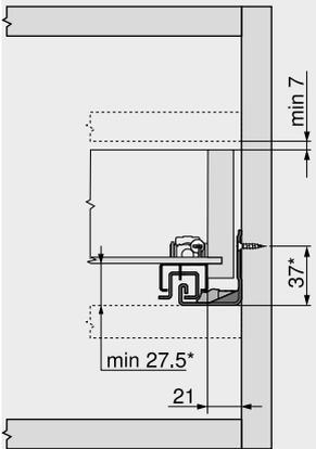
\* +3 mm con stabilizzatore laterale
